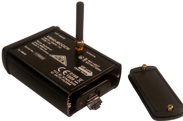
Bild 53: Wechseln der SIM-Karte
