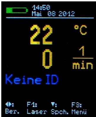
Bild 34: Drehzahl- und Temperaturanzeige
